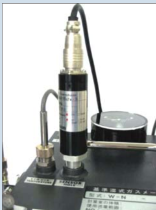
● 圧力センサ(VPRN-A2-1000型) 0~10kPa=1~5V DC出力 Pressur sensor(Model=VPRN-A2-1000) 0~10kPa=1~5V DC output
